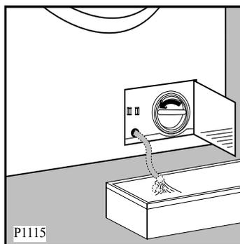
4. Wenn das Wasser vollständig abgelassen ist, den Deckel der Ablaufpumpe entgegen dem Uhrzeigersinn abschrauben und herausziehen.
