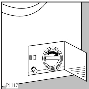
7. Die Grobkörperfalle einsetzen und den Deckel im Uhrzeigersinn wieder fest verschrauben.
